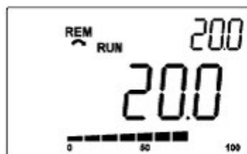
Figura 19.21: Ejemplo de HMI en modo monitoreo para la función Controlador PID2
